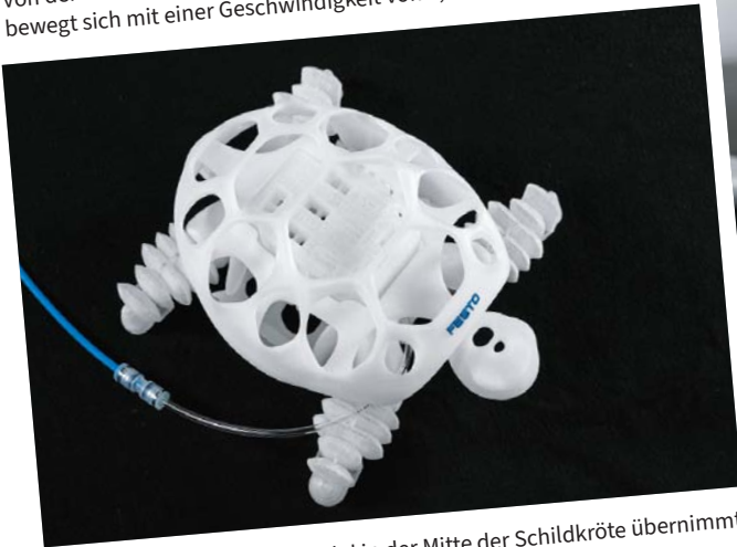
Jedes Bein besteht aus drei Luftkammern und besitzt dadurch drei Freiheitsgrade.
